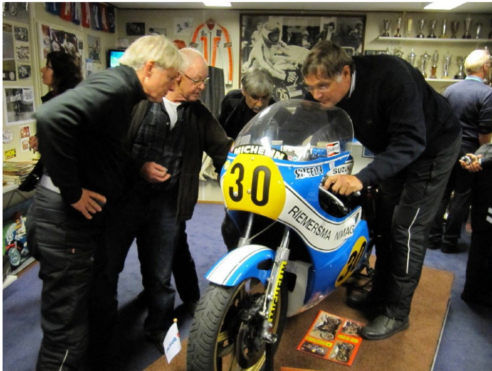
De motor waar vele races mee zijn gewonnen: de NIMAG Suzuki. Een 4-cilinder motor van 250 cc, met 4 krukassen en 120 pk
